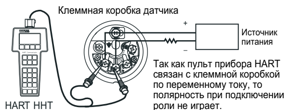
Рисунок 7.3 Подсоединение терминала HART (ННТ)
