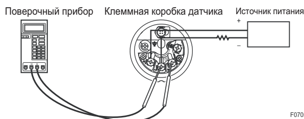
Рисунок 7.4 Присоединение поверочного прибора
