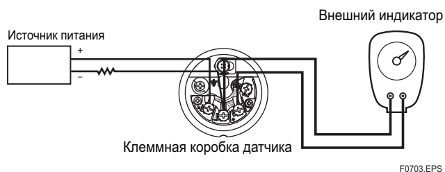
Рисунок 7.2 Подсоединение внешнего индикатора
