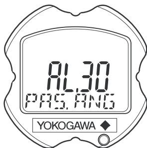
Отображение ошибки по результатам самодиагностики на внешнем индикаторе (датчик неисправен)
